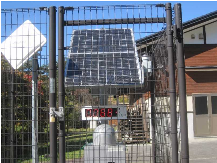
川内村内放射線量計(無線回線にてリアルタイムで文部科学省へ送信)
